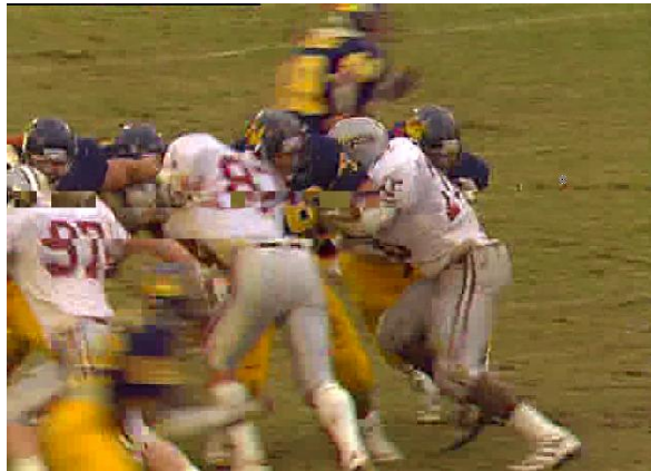
Ett B-frame IP paket tappat (1 frame påverkas)
