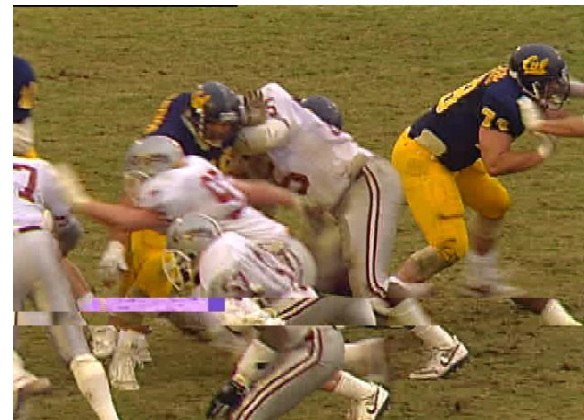
Ett I-frame IP paket tappat innebär att hela GOP (11 frames påverkas)
